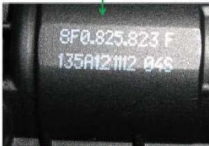
Ab Produktionsdatum 12.11.12 sind korrigierte Grundplatten verbaut worden
