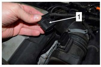
Disconnect Mass Air Flow (MAF) connector <1> -G70-.
