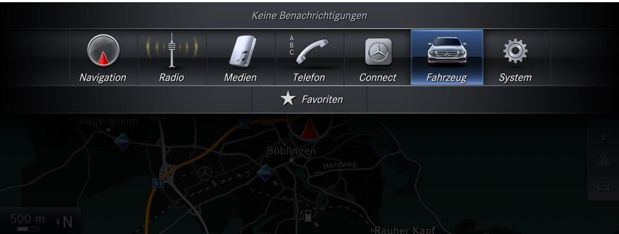
1. Den Menüpunkt „Fahrzeug“ markieren und anschließend die Zentrale Bedieneinheit gedrückt halten, bis das Dealer Menü erscheint
