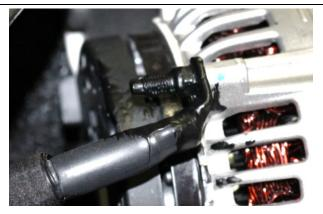
FIGURE 81: GROUND CONNECTION ON THE ALTERNATOR
