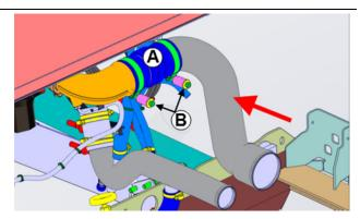
FIGURE 103: CONNECTION AT THE TURBO OUTLET ELBOW
