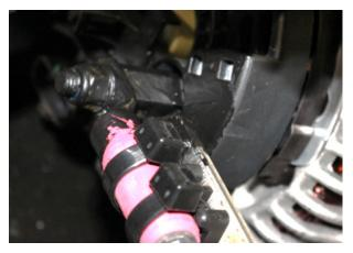
FIGURE 82: POSITIVE (+) CONNECTION ON THE ALTERNATOR
