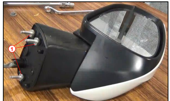
1 Original Stud Bolts
