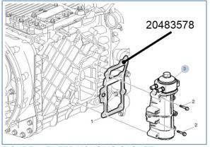
FIGURE 1: FILTER HOUSING GASKET
