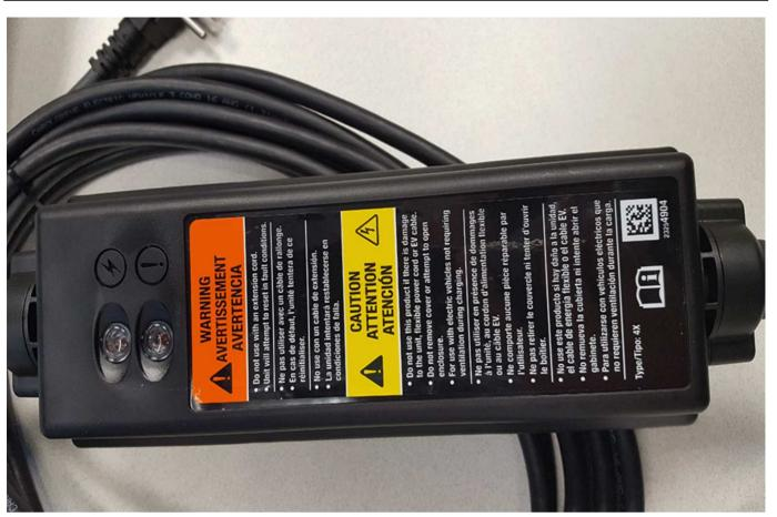
4883463 Ready to charge Prêt pour le chargement Listo para cargar Electrical outlet/plug overheated Surchauffe de la prise/fiche électrique Tomacorriente/enchufe eléctrico sobrecalentado System not properly grounded Pas de liaison correcte du système à la masse Sistema no conectado a tierra adecuadamente Vehicle fault detected Défaut du véhicule détecté Se detectó falla de vehículo Charge cord fault detected Défaut du cordon de chargement Se detectó falla del cable de carga
