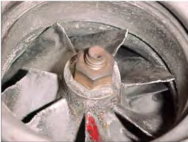
Daño de Rueda de Compresor Debido a Objetos Extraños
