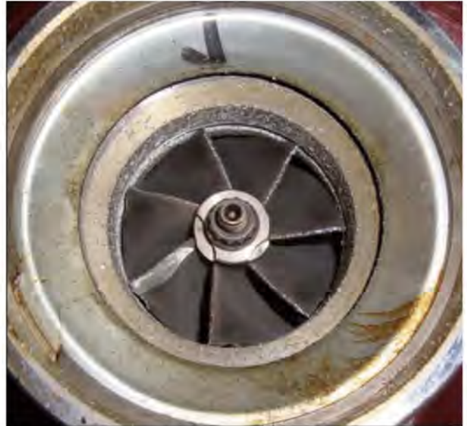
Daño de Rueda de Compresor Proveniente de Objetos Extraños
