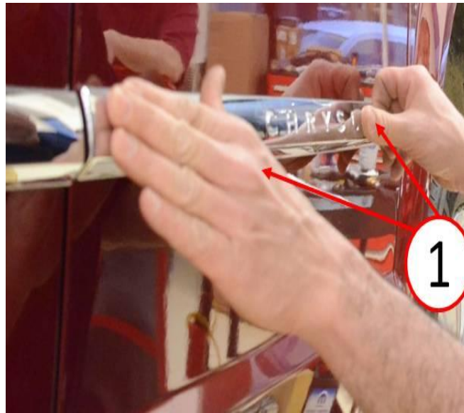
Fig. 5 Installing Right Door Molding
