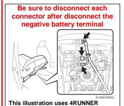
b) DISCONNECT THE FRONT PASSENGER SEAT CONNECTORS (Only 4RUNNER, PRIUS, PRIUS V)
